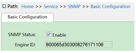
Figure 53 enable SNMP
