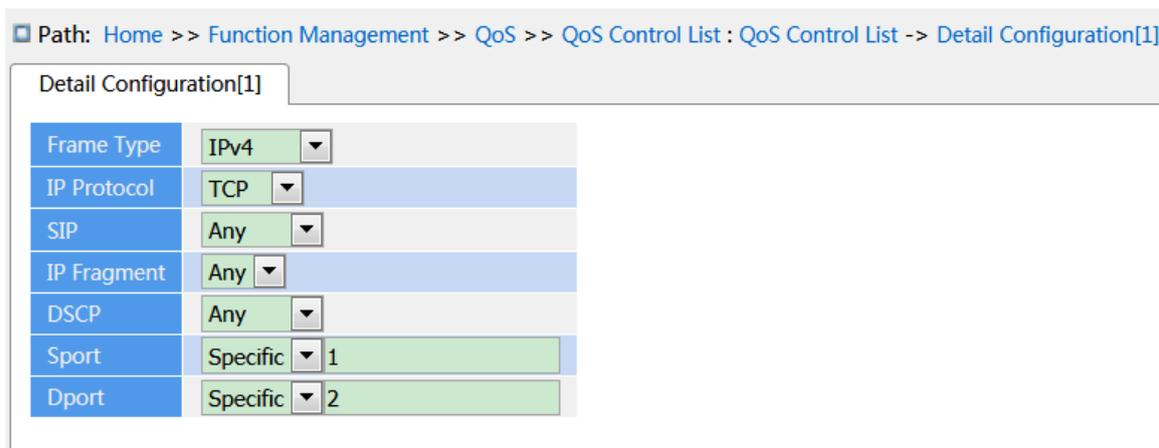
Figure 271 Configure IPv4 frame parameters
