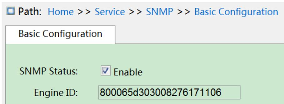
Figure 53 enable SNMP
