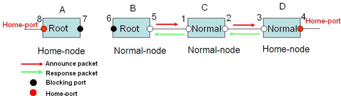
Figure 127 DHP Fault Recovery
